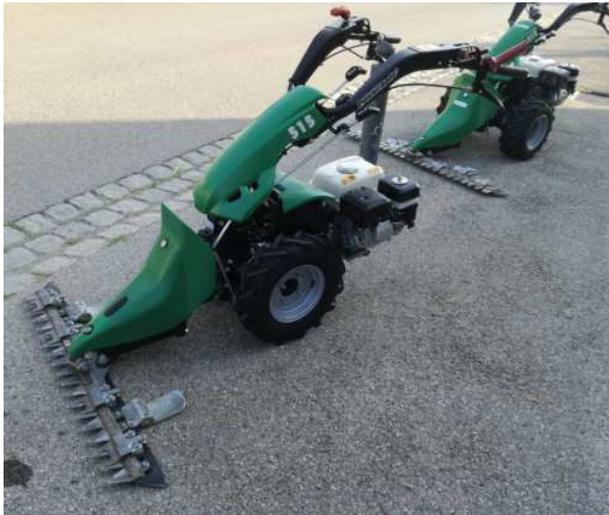
3,6 kW / 4,8 PS Honda Benzin-Motor GP160
